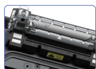
可拆卸 SOC热熔夹具
